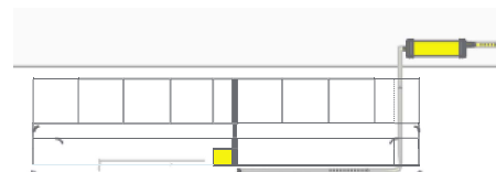
Sensor wody w klimatyzatorze, pompa na suficie.
